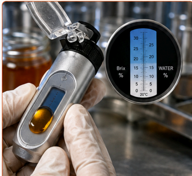
Análise de umidade por refratometria — procedimento essencial para controle de qualidade do mel de meliponíneos.
